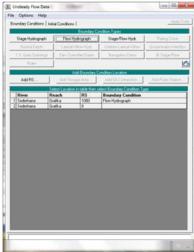
Gambar 37: Layar editor data aliran tak permanen setelah pengisian data hidrograf debit sebagai syarat batas hulu di RS 1000
