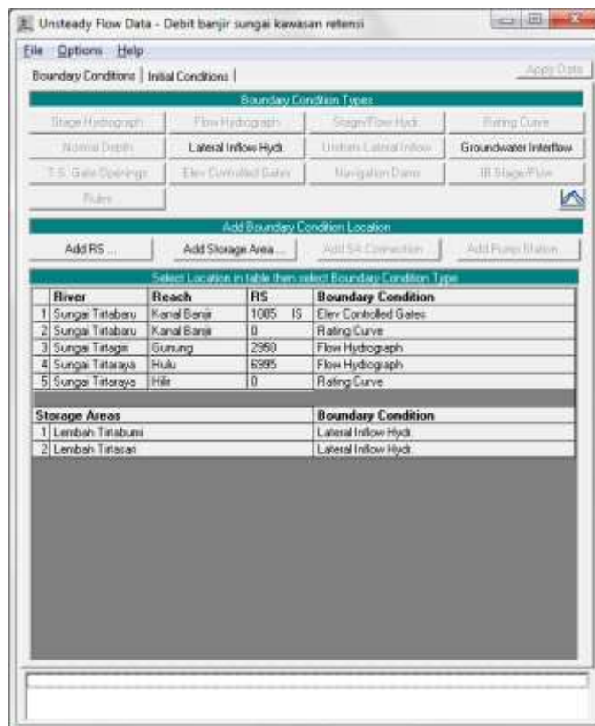
Gambar 175: Layar editor data aliran tak permanen setelah semua data syarat batas dan syarat awal selesai dimasukkan kedalam HEC-RAS
