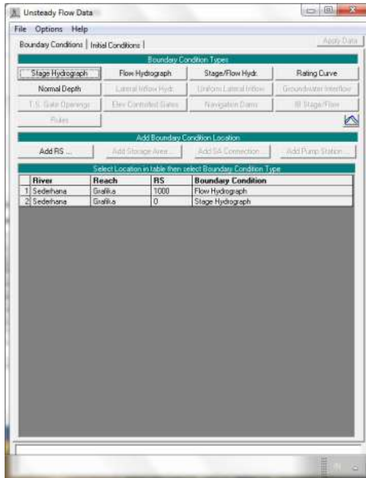
Gambar 39: Layar editor data aliran tak permanen setelah pengisian data hidrograf muka air sebagai syarat batas hilir di RS 0
