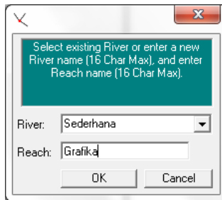
Gambar 10: Layar pengisian nama saluran (sungai) dan ruas saluran pada layar editor data geometri
